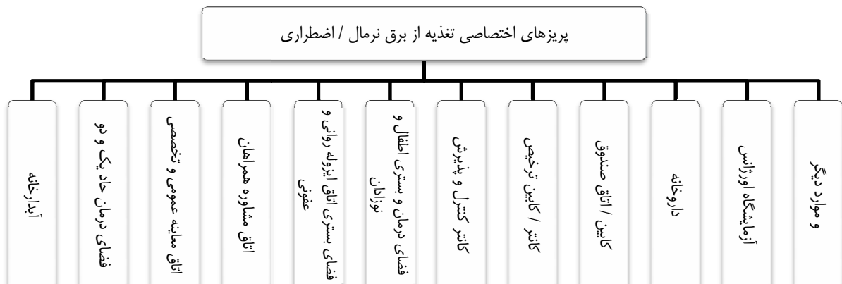
شکل ۵-۱۱- پریزهای اختصاصی تغذیه از برق نرمال / اضطراری
