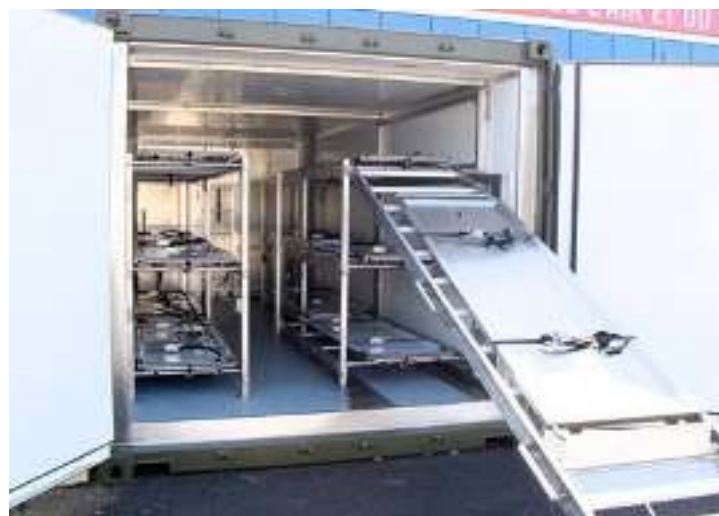
شکل ۱۱-۴ کانتینر انتقال اجساد (سردخانه اجساد)
