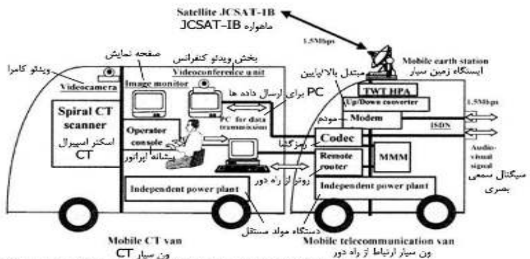
Fig. 1. Schematic diagram of the mobile unit housing spiral CT and telecommunication equipment. طرح کلی سی تی اسپیرال و تجهیزات از راه دور
