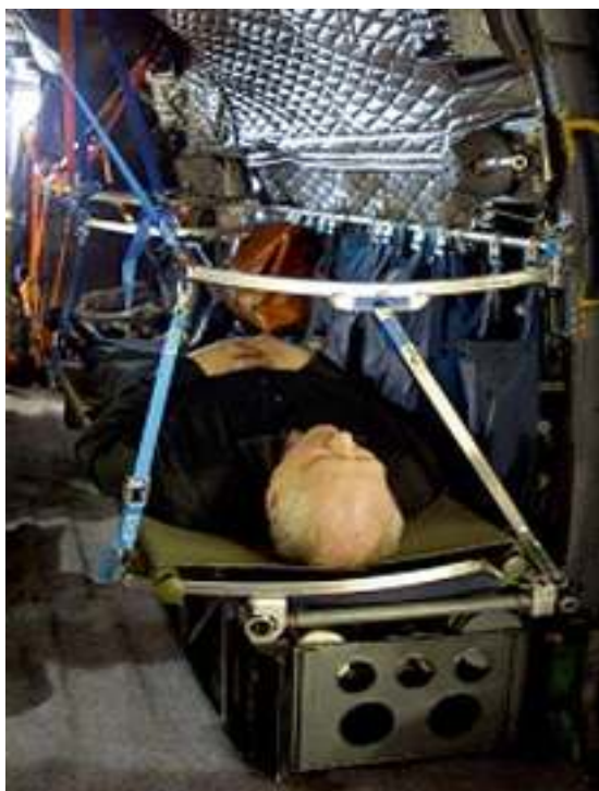
شکل ۵-۲۵ انتقال مصدومان توسط هواپیماهای باری یا نظامی با تعبیه فضاها و تخت‌های خاص در بدنه داخلی آنها
