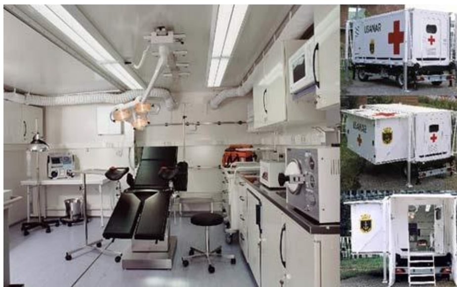
شکل ۱۰-۲ اتاق عمل کانتینری برپا شده روی پاورپک
