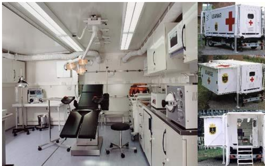
شکل ۱۰-۲ اتاق عمل کانتینری برپا شده روی پاورپک
